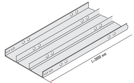
İsteğe bağlı olarak yükseltilmiş döşeme altı kablo kanalları tek ve çift seperatörlü olarak imal edilebilir.
